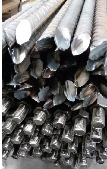
Toinen pää viistottu ja kierrepään pää litistetty
